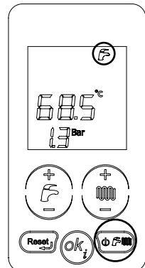
**3.** Если вы не хотите включать функцию отопления, нажмите несколько раз на кнопку "выбор режима работы котла", пока на дисплее не появится символ : будет включена только функция ГВС (горячее водоснабжение).
