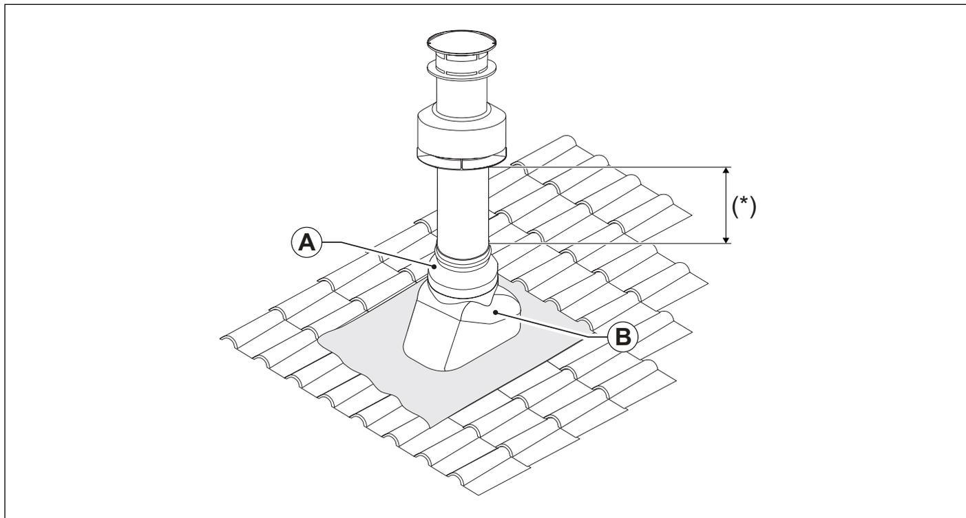
Рис. 15 Установка димоходу на даху
