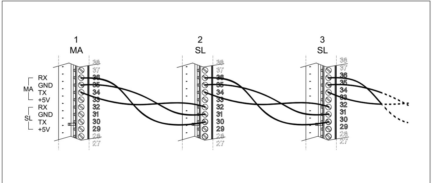
Рис. 26 Інформація щодо з'єднання
