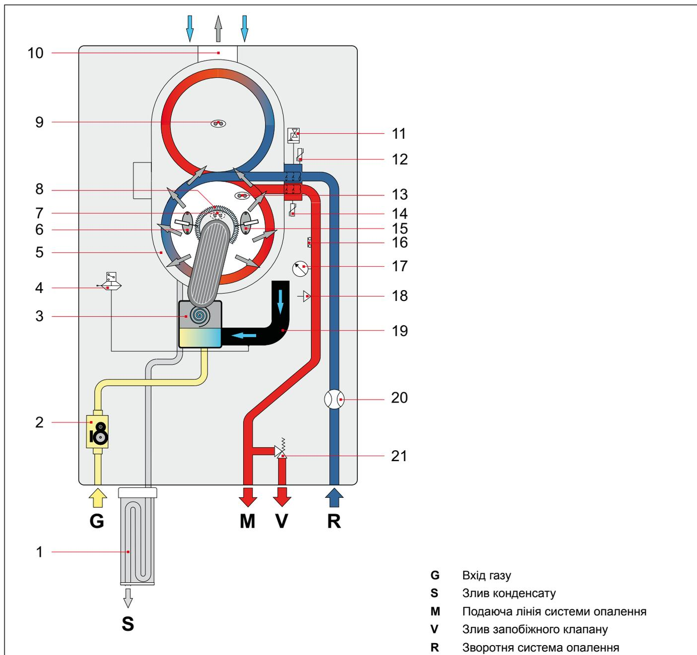
Рис. 6 Схеми гідравлічних підключень
