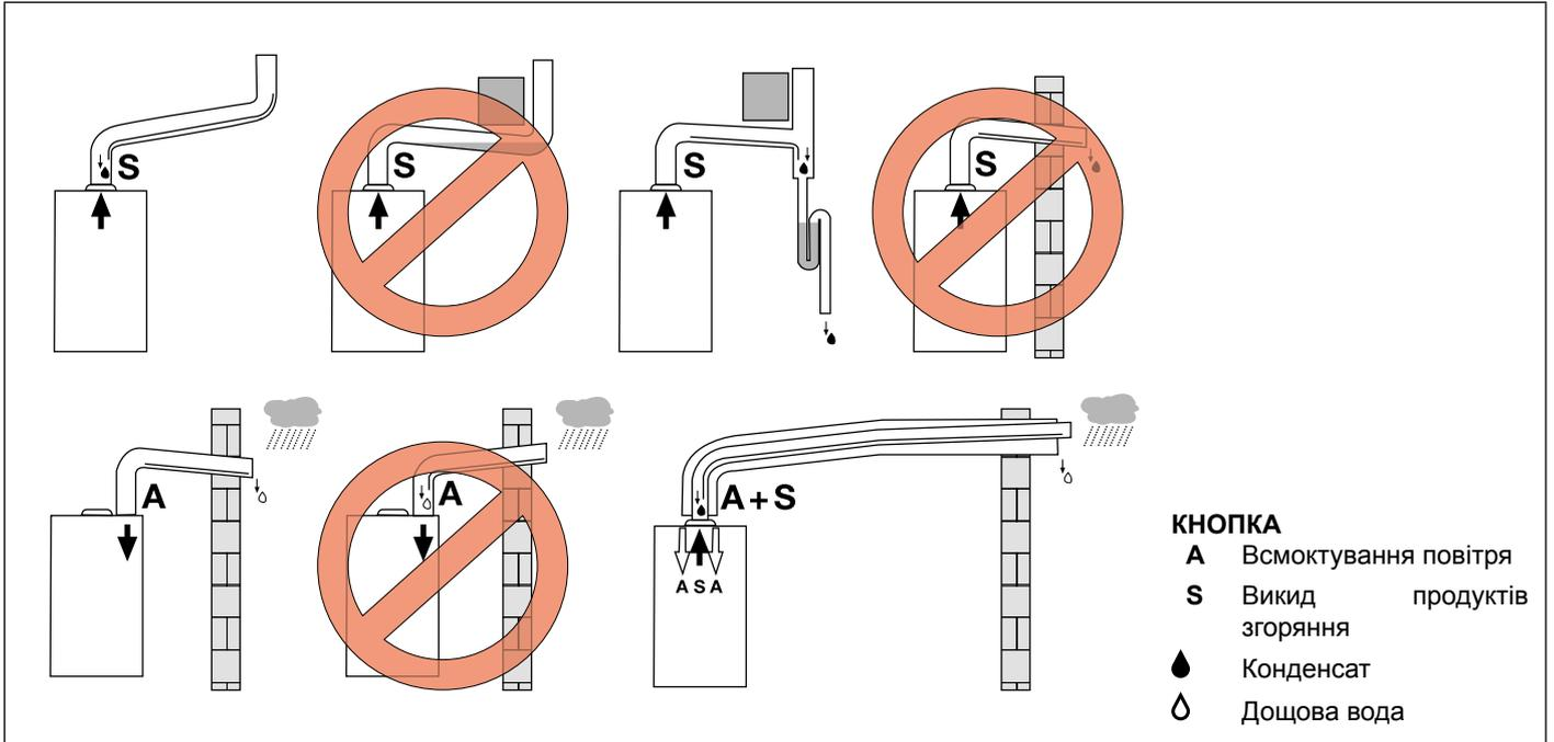
Рис. 11 Приклади монтажу
