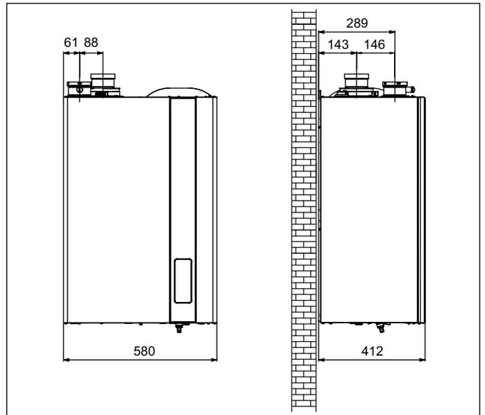
Fig. 18 Dimensiones conductos desdoblados tipo C43 - C53 - C83
