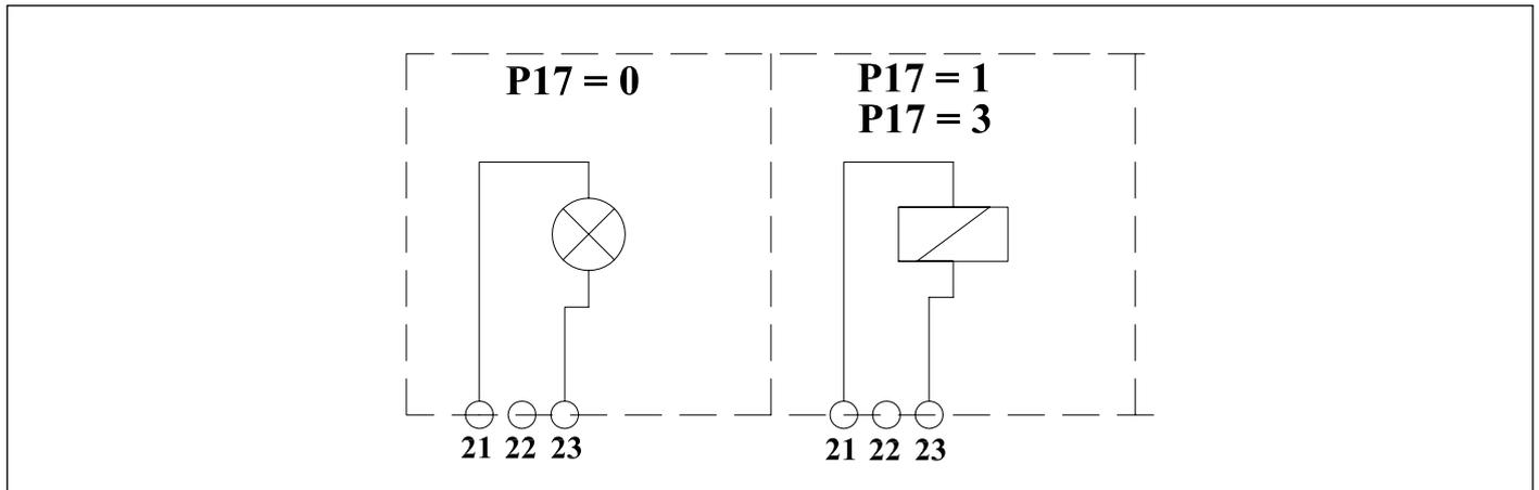
Fig. 26 Esquema de conexión relé multifunción
