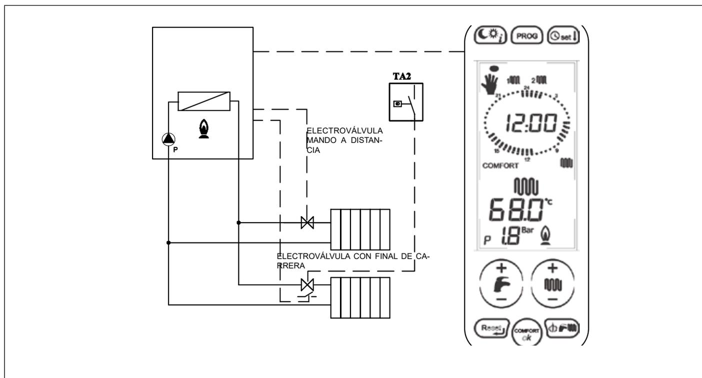
Fig. 28 Relé con programación interfaz y TA2
