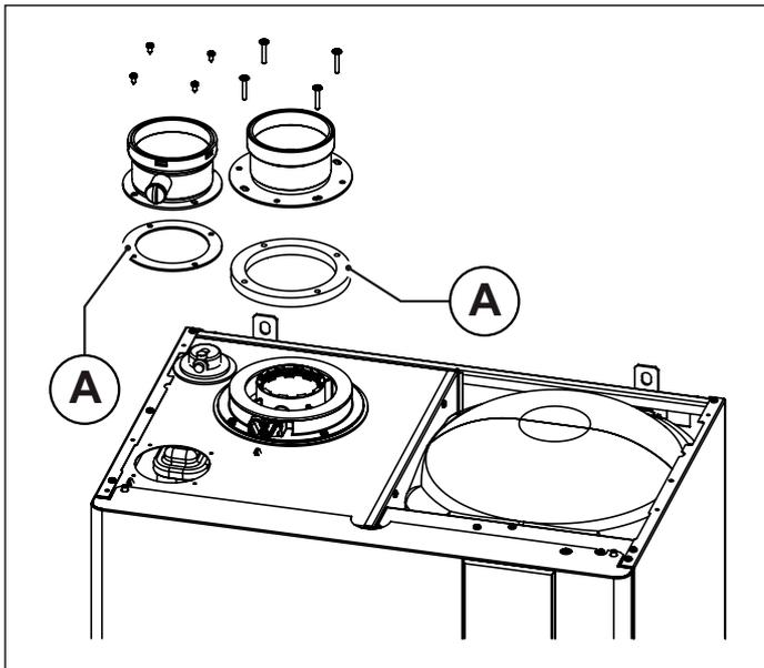
Fig. 17 Conductos desdoblados tipo tipo C43 - C53 - C83
