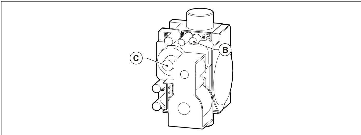
Fig. 36 Regulación valor anhídrido carbónico
