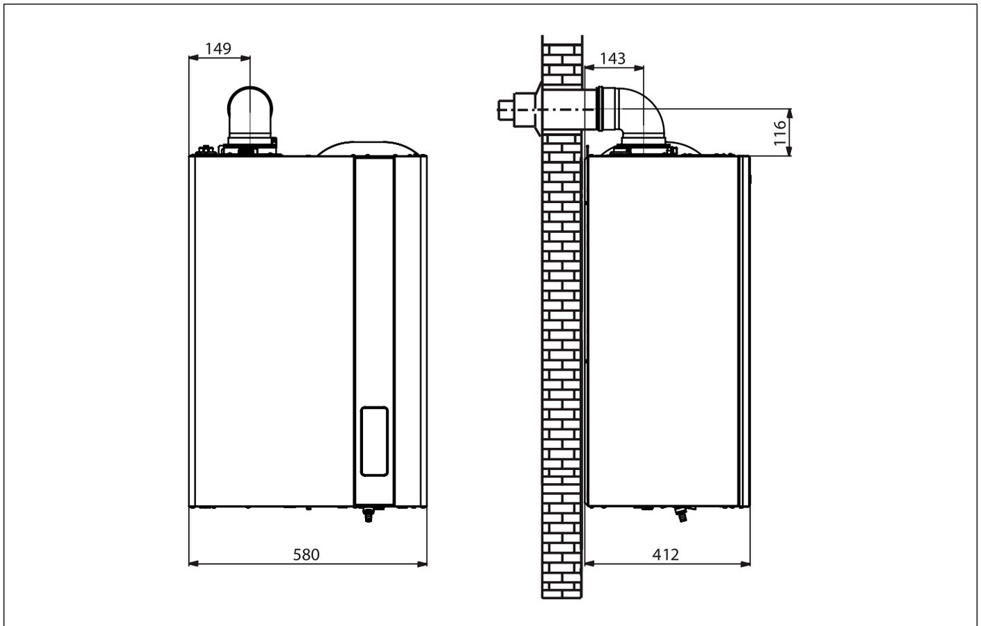
Fig. 16 Dimensiones conductos coaxiales tipo C13 - C33
