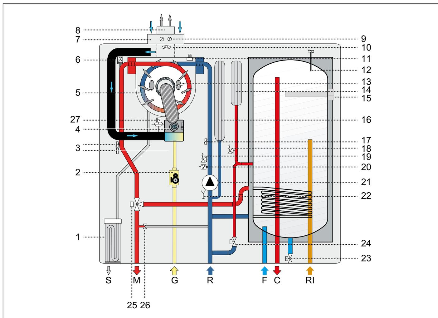
Fig. 5 Esquema hidráulico
