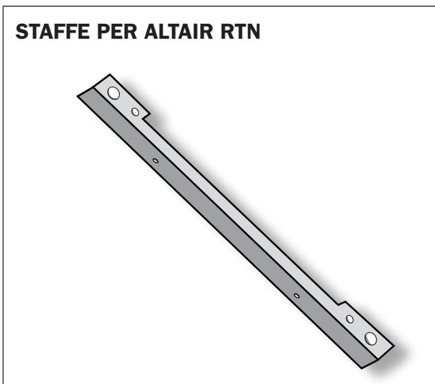
Sulla faccia superiore del bollitore (superficie di appoggio), sono situate delle coppie di fori che consentono di fissare le staffe a seconda della dimensione della caldaia:
